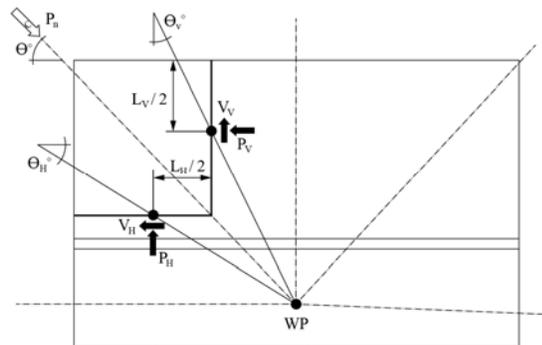
Figure C6A.6.12.6.11-1—Basic Corner Check
