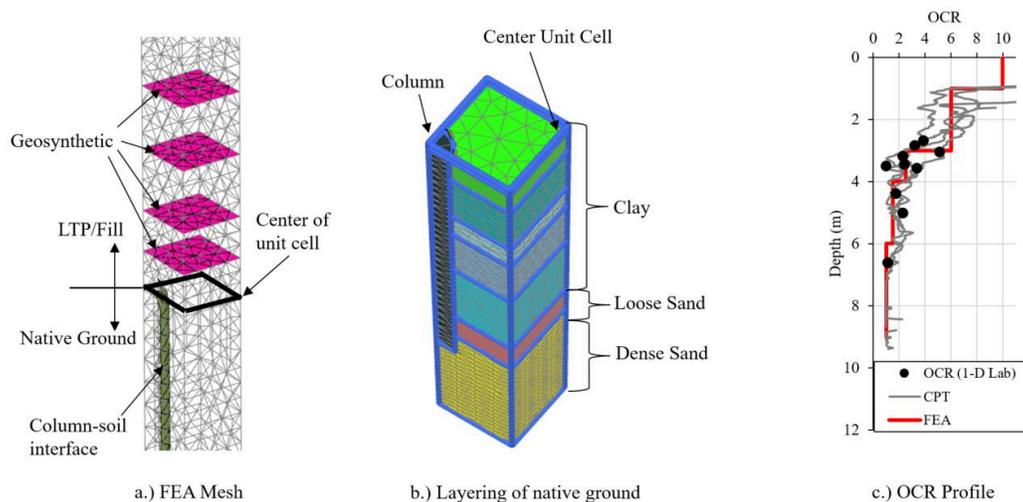
**Figure 9: a.) FEA mesh; b.) FEA Layering; c.) OCR used for FEA**
