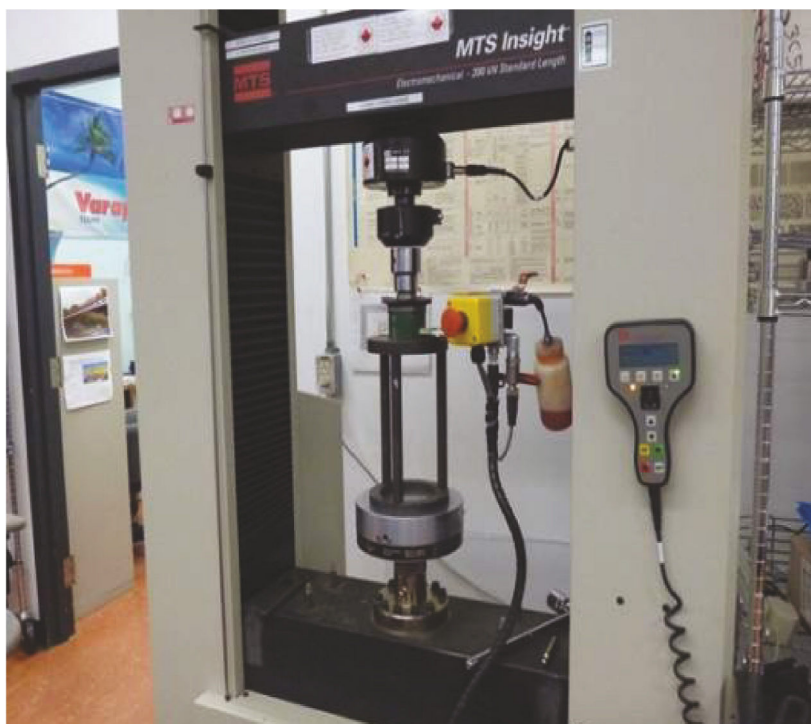
Bild D.6 — Illustration des Kalibrierprozesses des LAMI mit einer Hydraulikpresse, die mit einer 10-kN-Lastmessdose ausgestattet ist
